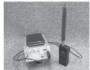
Рис. 5. Узел UWB-радиосвязи DRACO (ручной интерфейс MBITR — справа, UWB-приемопередатчик с блоком обработки сети — слева)
