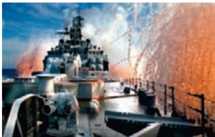
Применение комплекса постановки пассивных помех ПК-10
