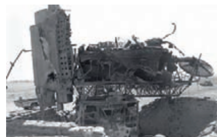
Станция наведения ракет ЗРК С-75 после попадания ПРР
