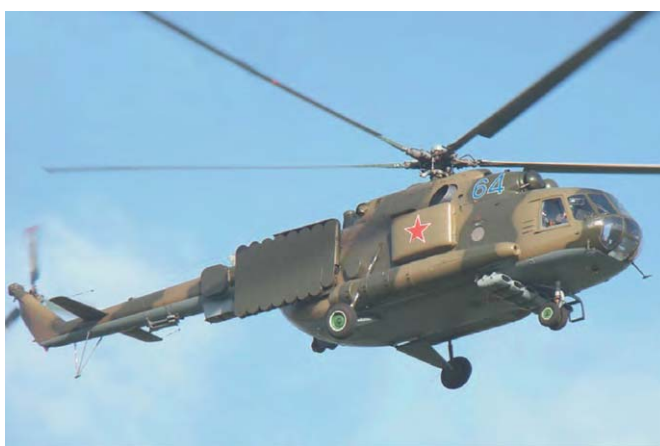
Рис. 6. Станция мощных помех
