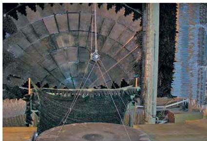
плекса «Сектор», позволяющего оценивать заметность не только моделей, но и уже реальных малогабаритных объектов и их составных частей. Также был создан комплекс по измерению характеристик радиопоглощающих покрытий и материалов «Панорама».
