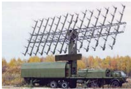
Развернутая на позиции наземная радиолокационная система «Небо-СВУ»
